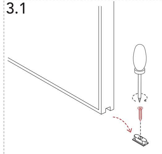
Fissare il perno a pavimento prima di infilare l'anta.
