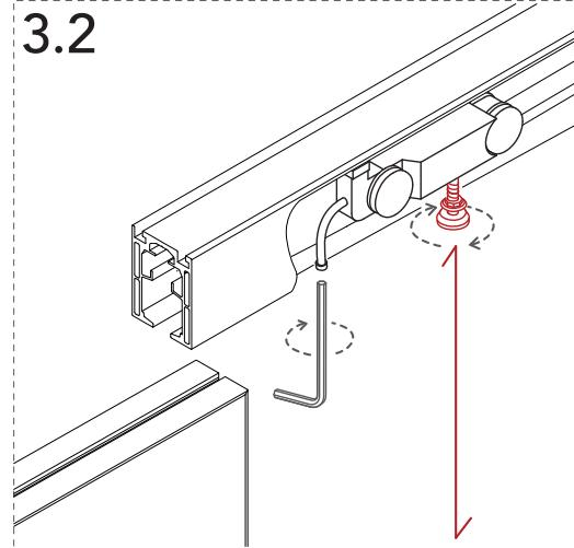
Regolare l'altezza delle viti dei carrelli e infilare l'anta.
