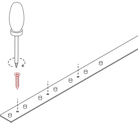
Fissare la guida a pavimento allineandola al binario.
