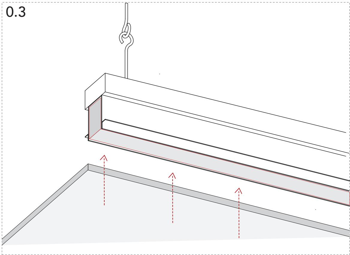
Fissare il cartongesso al falso binario rispettando la quota pavimento falso binario
