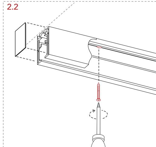
Fissare il binario direttamente al soffitto.
