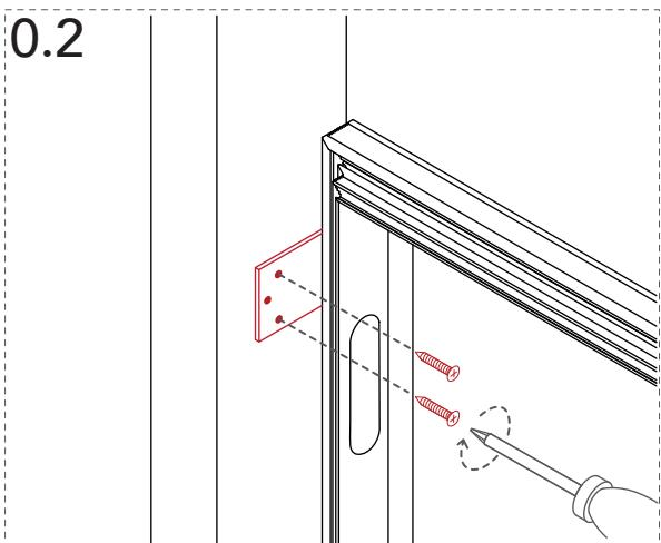
Fissare il telaio con le zanche ai montati.
