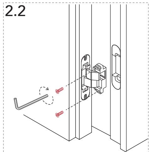
Inserire l'anta nel telaio e avvitare le cerniere.
