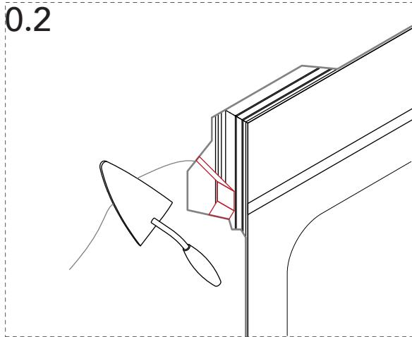
Inserire il telaio e cementare.
