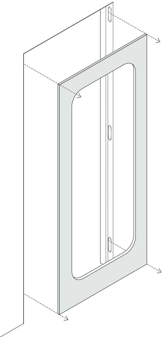
Rimuovere l'irrigidimento solo dopo aver ultimato e verificato la corretta installazione del telaio.
