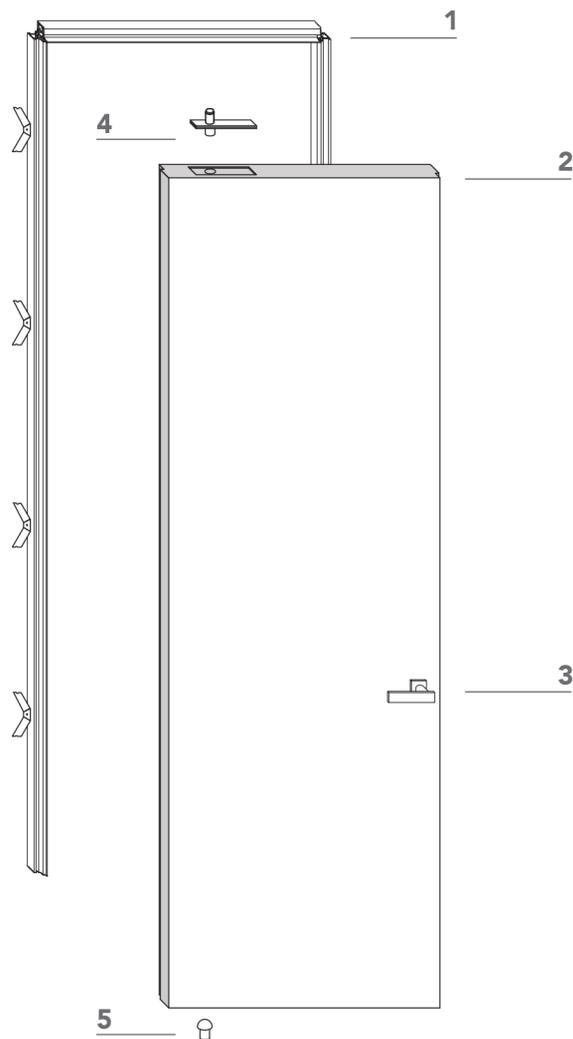
**1** telaio in alluminio anodizzato preassemblato da murare senza falso telaio;
