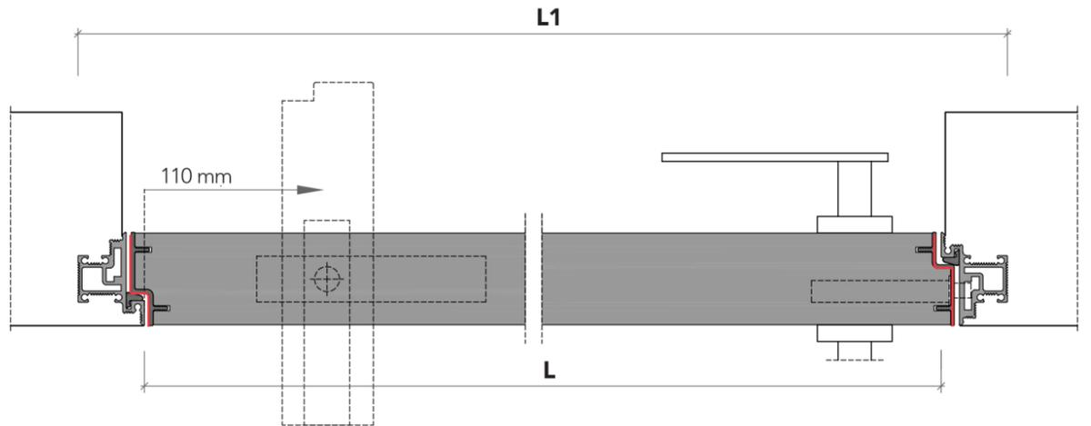
riduzione spessore per rivestimenti (2 o 4 mm) - thickness reduction for cladding (2 or 4 mm)
