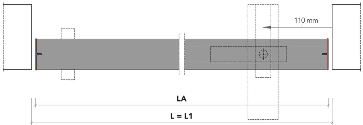
riduzione spessore per rivestimenti (2 o 4 mm) - thickness reduction for cladding (2 or 4 mm)
